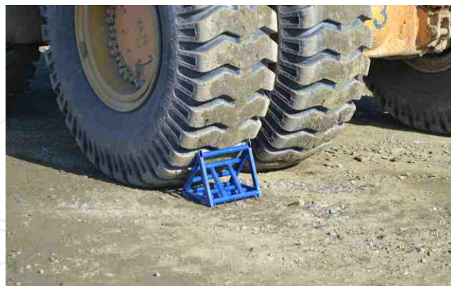
Установка упоров под колеса во время остановки самосвала
