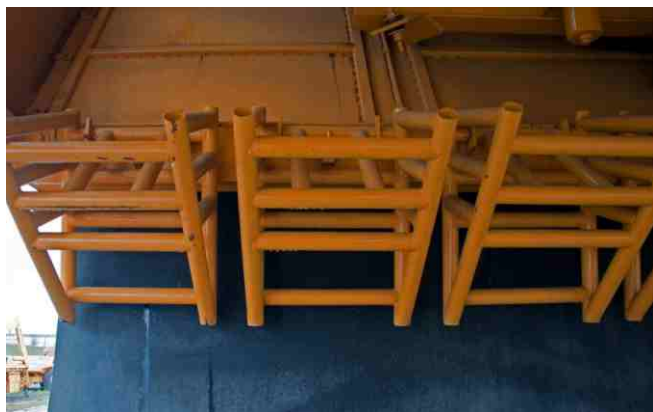
Крепление упоров на штатные места во время движения самосвала
